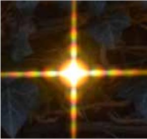
**Abb. 5:** Beugungsmuster, das beim Durchgang von weißem Licht einer LED durch ein feinmaschiges Drahtnetz (Insektenschutzgitter) entsteht<sup>23</sup>. Foto: W. Czieslik
