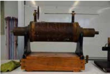
**Abb. 3:** Funkeninduktor aus der Sammlung des Katharineums zu Lübeck, vermutlich 19. Jahrhundert. Der Funkeninduktor diente zur Erzeugung der Hochspannung für die Röntgenröhre.<sup>5</sup> Foto: W. Czieslik
