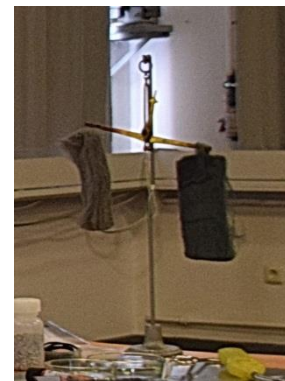
Abb. 3: Stahlwolle an der Waage; links unverändert, rechts: verbrannt
