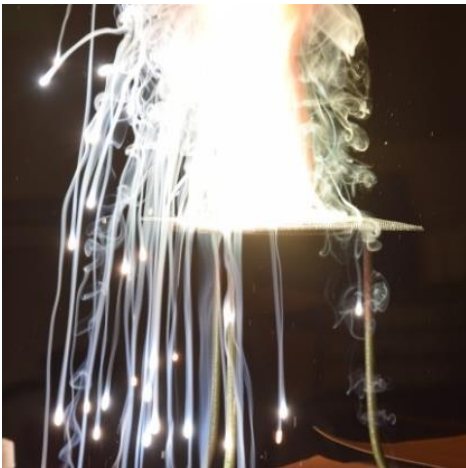
Abb. 8: Stichflamme durch die Bildung von Wasserstoff
